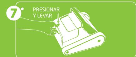
Para acceder al cesto filtrante del robot, no fuerce la compuerta de acceso, simplemente presione hacia abajo y levante la tapa con la pestería de abajo.
