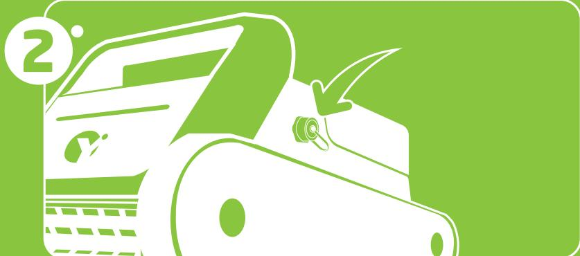
Vérifiez que le bouchon étanche de charge est vissé complètement avant de le mettre à l'eau.
