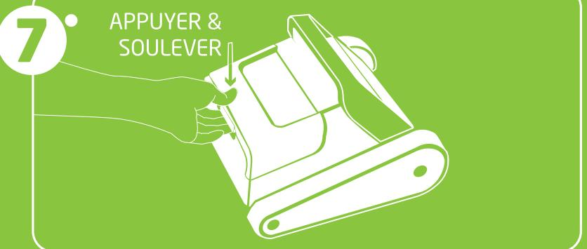
Pour accéder au bac filtrant du robot, ne forcez pas sur la porte d'accès, il faut appuyer et soulever simultanément le capot.
