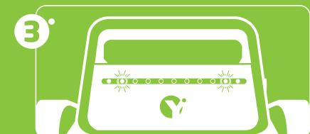
Coloque el robot en un suelo llano y espere (unos 50 segundos) hasta que parpadeen las luces LED en amarillo antes de meterlo en el agua.
