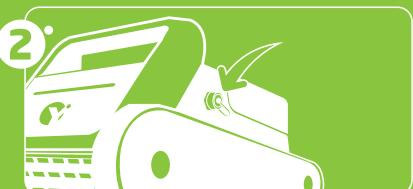
Compruebe que el tapón de carga estanco del robot esté enroscado correctamente hasta el final antes de meterlo en el agua.
