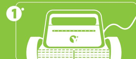
Cargue completamente el robot antes del primer uso. Todas las luces LED deben estar encendidas en verde.
